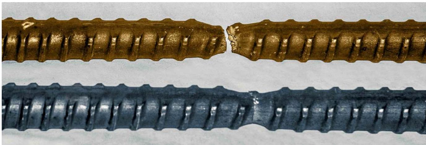
Разрыв SAS 500/600 при -165°C—> сужение отличается высокой пластичностью
